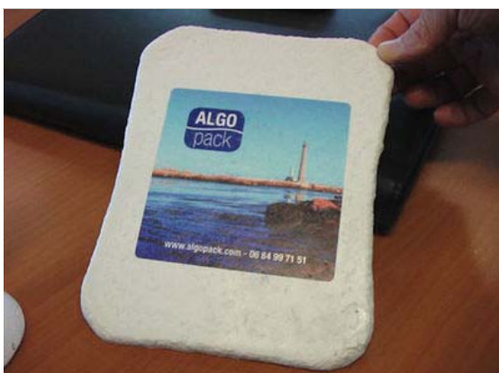
Écologique et local : Algo-pack, le plastique " sans plastique " fabriqué sur place à base d'algues récoltées sur les côtes bretonnes, offre une solution durable pour remplacer le plastique rigide.
